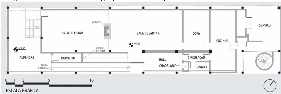
Imagem 03 – Residência Bettega: planta baixa do pavimento inferior
