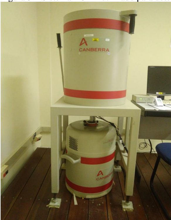
Figura 3 – Sistema EGAR utilizado para determinação de radionuclídeos naturais nos solo
