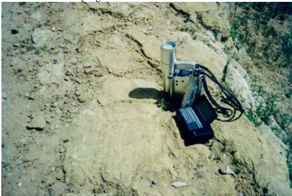
Figura 1 – Afloramento de fosforito uranífero em Paulista, Pernambuco, encontrado com auxílio de um detector de radiação gama ambiental.
