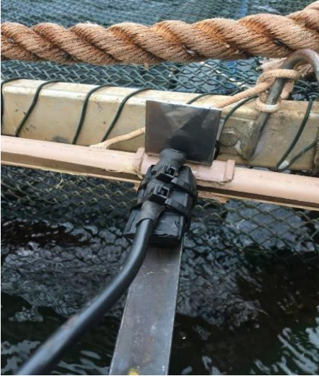
Figura 4 - Sensor TCRT5000 e ponto de referência
